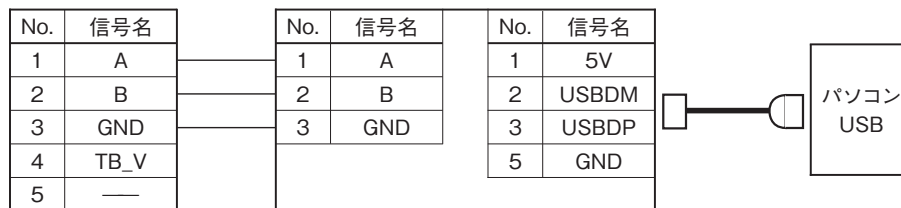
端子配列及び配線(USB-RS485変換器-パソコン)
